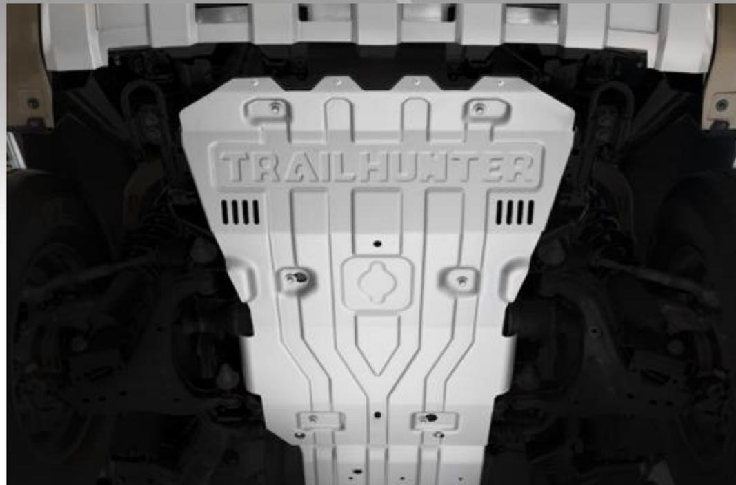
**Placa de deslizamiento (Skid Plate)**
